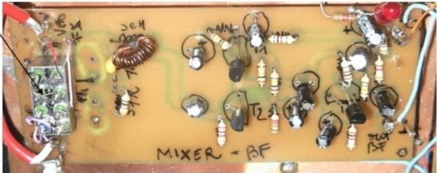
Circuit imprimé Mélangeur SBL-1 + Diplexeur + Découpleur + BF
