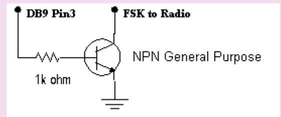
Votre radio effectue la modulation par déplacement de fréquence à l'intérieur, de sorte que tout ce dont vous avez à vous soucier est de fournir une modulation marche/arrêt. Pour montrer à quel point ce concept est simple, branchez un câble à extrémité ouverte (2 conducteurs) dans l'entrée FSK de votre émetteur.
