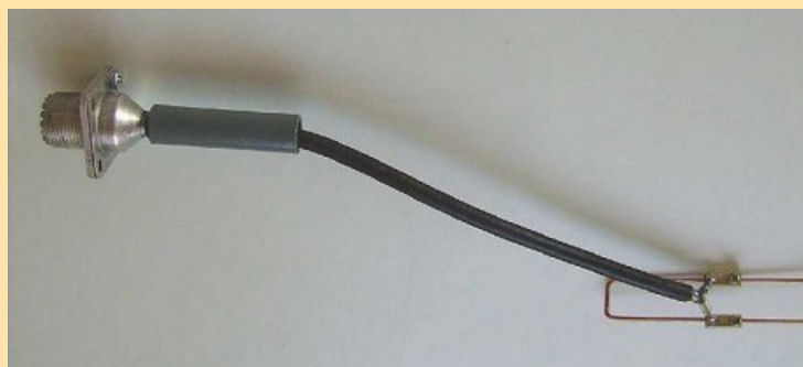
Coaxial avec tube ferrite.
