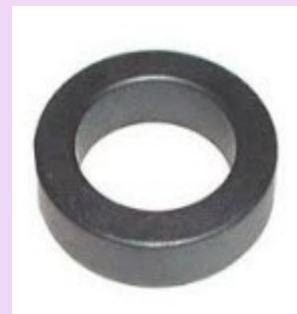
Le **ferrite** est une céramique ferromagnétique<sup>1</sup> obtenue par moulage à forte pression et à haute température (>1 000 °C) à partir d'oxyde de fer  $Fe_2O_3 \cdot XO$  (où X : manganèse, zinc, cobalt, nickel, etc.). Il est très utilisée en électronique et permet de mettre en œuvre des applications diverses et variées grâce à ses propriétés.
