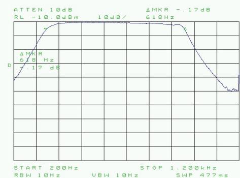
Fig. 47 : Relevé de la courbe d'un filtre à quartz moyenne fréquence d'une largeur de bande de 500 Hz en réception CW et à la sortie audio du récepteur (FT-736).
