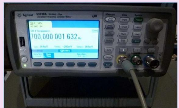
Fig. 46 : Exemple de la mesure de réponse d'un filtre à quartz moyenne fréquence de 500 Hz pour CW (FT-736). La courbe de réponse est relevée à la sortie audio du récepteur. On voit que le BFO (*Beat Frequency Oscillator*) du récepteur donne un *tone* audio de 700 Hz. La fréquence du générateur HF est ajustée plus haut et plus bas afin de mesurer la fenêtre de réception, autrement dit la bande passante du filtre moyenne fréquence.
