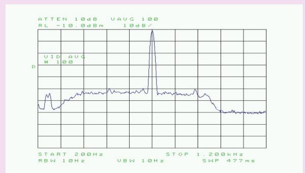
Les filtres réjecteurs sont utilisés au niveau de la chaîne audio d'un récepteur afin d'éliminer des tonalités gênantes qui sont issues de porteuses parasites lors de la réception en SSB. Ces filtres sont en général constitués à base de DSP et la fréquence d'accord du filtre réjecteur est accordée manuellement ou automatiquement par l'activation d'une fonction appropriée au récepteur.
