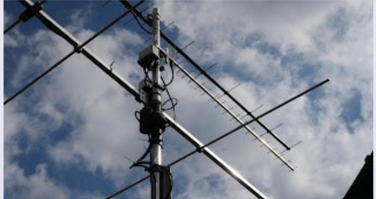
Antenne WIMO 28 éléments entre 70 cm et 4 m Yagis
