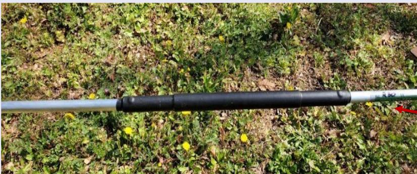
2 radiants 40 et 2 radiants 30 mètres Ceux ci sont "raccourcis" par "bobinage"
