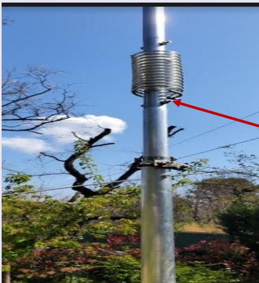
Les réglages de l'antenne avec un analyseur se font sur la hauteur de l'antenne et sur la longueur des radians .
