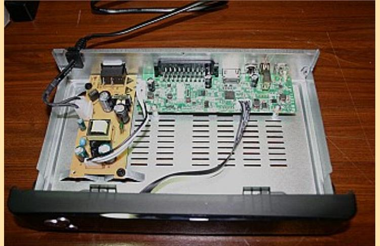
L'interconnexion de l'alimentation existante avec la nouvelle se fait comme suit, d'où la tension de sortie du nouveau module légèrement supérieure à 12V :
