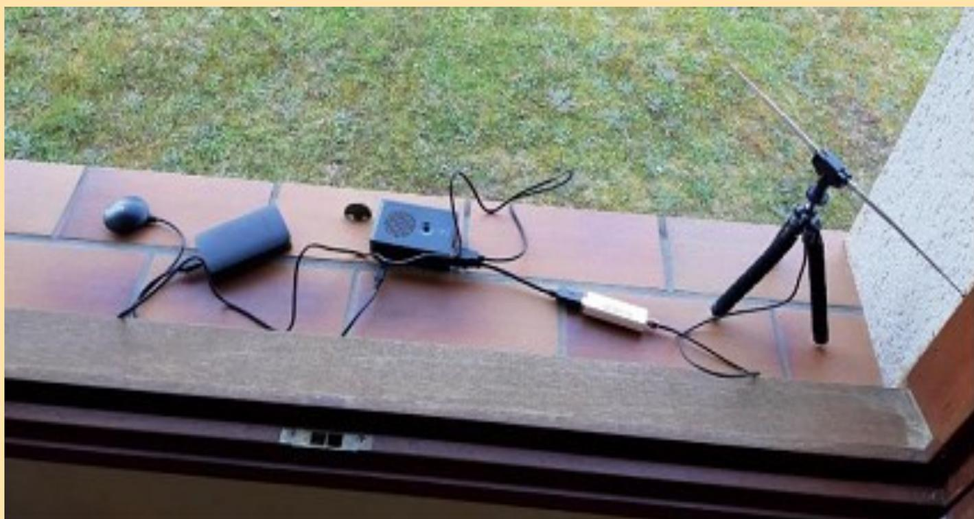
Un GPS, une batterie, une Raspberry Pi, clef SDR, et un mini dipôle sur 402 MHz
