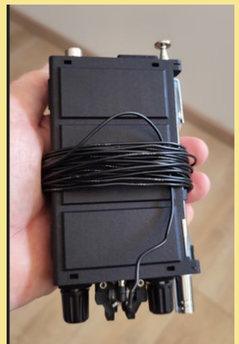
Le KH1 en position de rangement avec son contrepoids enroulé autour du boîtier.
