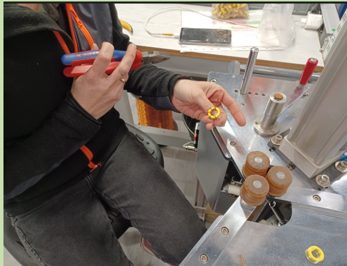
Fabrication des selfs des filtres de bande
