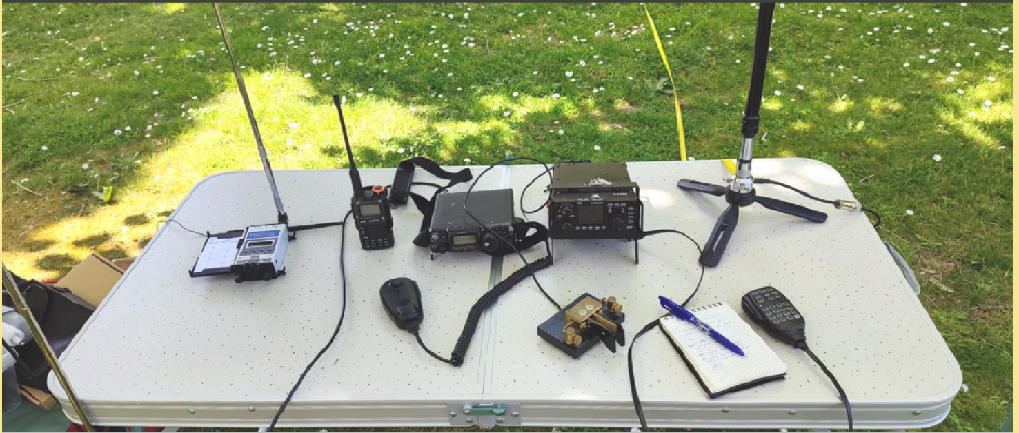
La station F6CYK/P en Field Day le 1er mai 2026 : de g. à dr. le KH1, l'UVK5, le FT817ND, le Xiegu G90 et les antennes correspondantes
