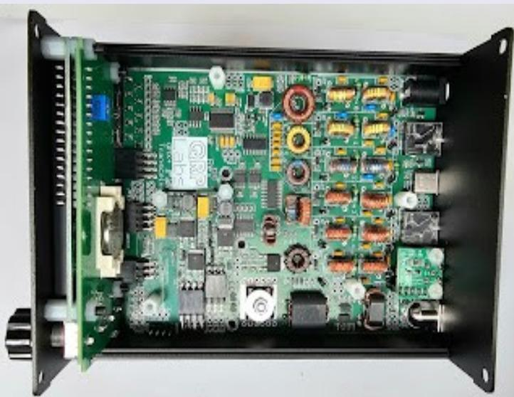
Une nouvelle plate-forme QRP complète de 160 m à 6 m en modes CW et numérique. (SSB sera disponible dans une prochaine version du firmware).
