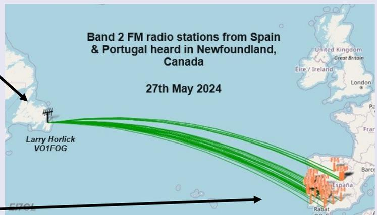
Les fréquences vont de **87,6 MHz** à **102,4 MHz** et les distances vont de **3 632 km** à **4 136 km**.
