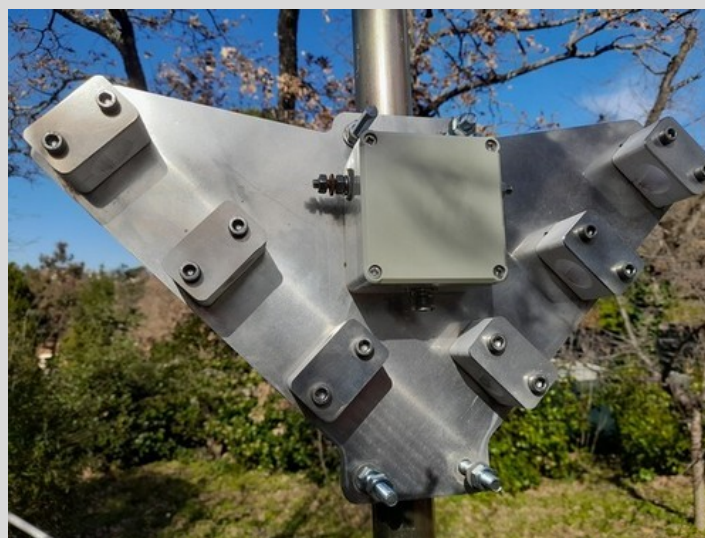
Percer et fixer les isolants puis le balun 1/1
