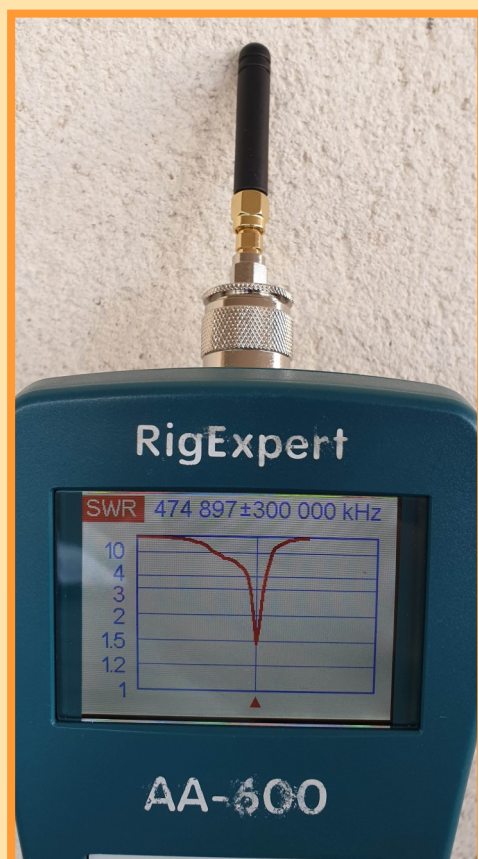
L'antenne est accordée sur 475MHz
