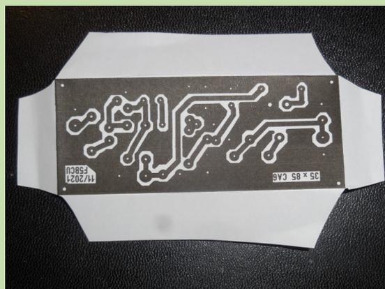
3° Prendre une plaque en époxy cuivré simple face et la découper aux mêmes dimensions que la copie imprimée côté cuivre en PDF échelle 1/1.
