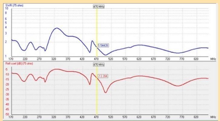
Nous pouvons observer le ROS en fonction des bandes passantes, (agrandir le PDF) ainsi qu'un comportement anormal entre 230 et 470 Mhz, ce qui est hors bandes télévision.. Nous verrons pourquoi en observant le mètre sur le schéma de l'antenne :
