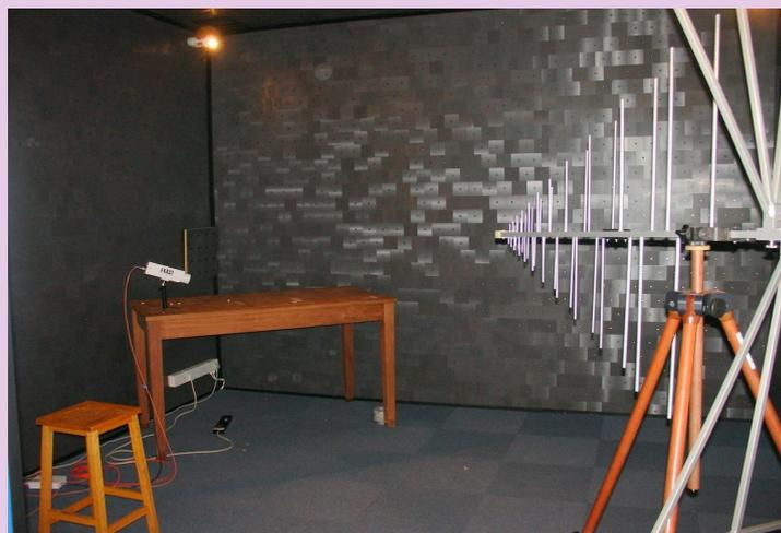
Chambre radiofréquence (RF) anéchoïque utilisée pour les tests CEM
