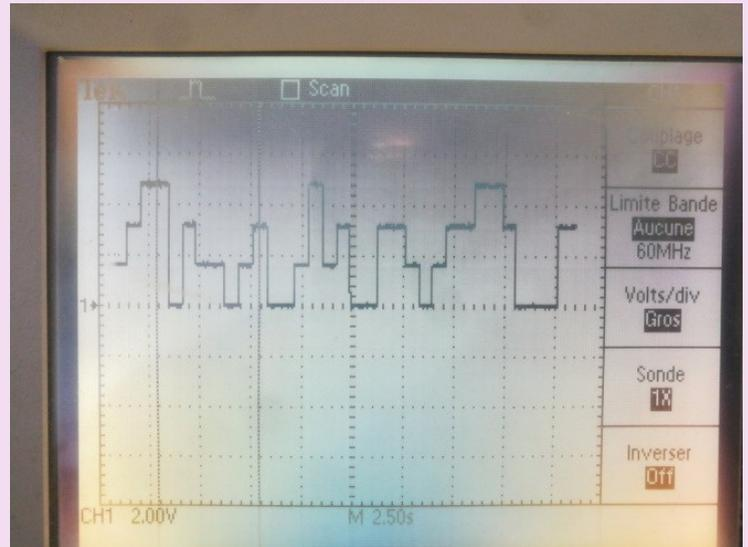
Test WSPR sur sortie CH1 à 19dbm (AMPL: 5V) →
