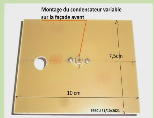
3° Le condensateur Variable FM de 2 x 20 pF est monté sur la façade avant
