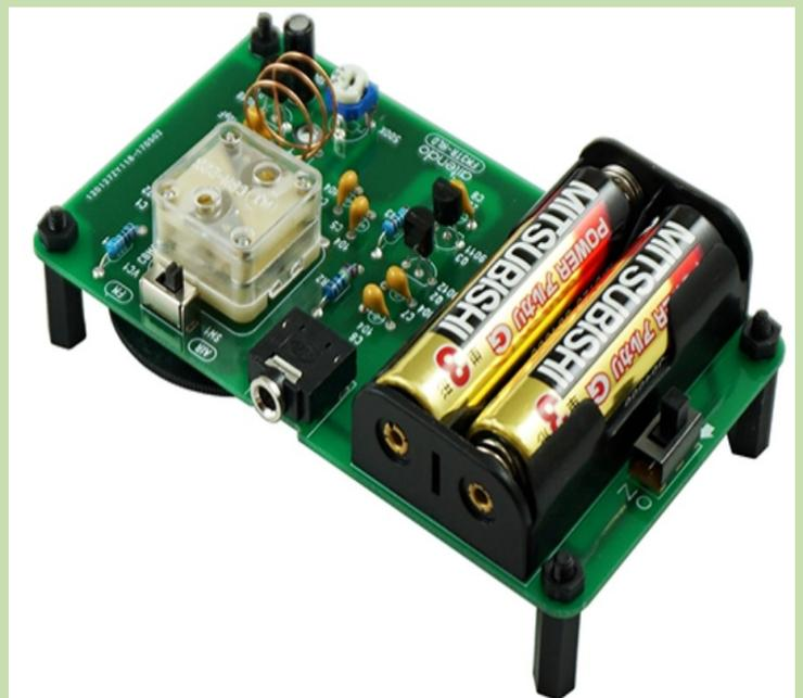
VERSION COMMERCIALE DU RECÉPTEUR SUPER RÉACTION
