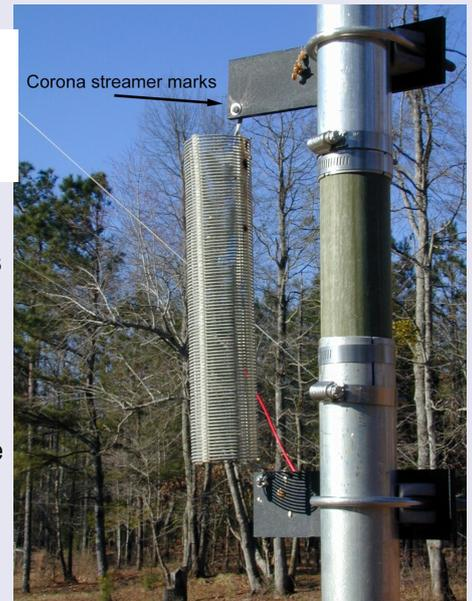
Les inductances à faible réactance inductive sont beaucoup moins critiques vis-à-vis des capacités parasites internes et externes. Le facteur de forme optimal dans une inductance à faible réactance se penche vers une bobine courte dont le diamètre est presque égal à la longueur.
