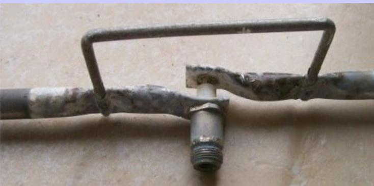
La plupart des gens qui possèdent ce genre d'antennes, se plaignent qu'il y a du ROS en temps d'humidité, pluie, etc...rien d'étonnant, voici dans quel état se trouve le bêta match, après que l'enveloppe se doit dégradée avec le temps :
