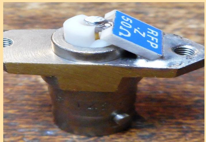
**protections mécaniques & poussière** N & BNC femelle par gaine thermo rétractable & colle, le connecteur APC 7 mm hermaphrodite inutilisé en extérieur n'est pas protégé : noter le soin apporté au plan de référence d'autant plus qu'il sert en hyper (banc 8410)
