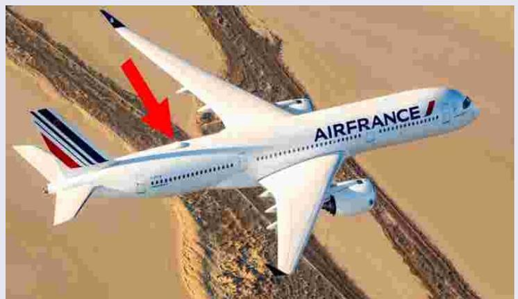
Ce nouveau système Wi-Fi, qui repose sur les satellites en orbite autour de la Terre, offre une meilleure connectivité et couverture que le précédent. L'ancien système s'appuyait en effet sur des récepteurs disposés sous le fuselage et qui communiquaient avec des antennes relais au sol. Le débit était donc beaucoup plus lent et au-dessus des océans le système était bien évidemment inopérant.
