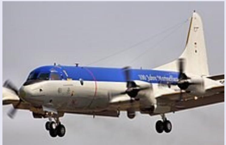
Antennes obliques 2 à 23 MHz, tendue de la coque de l'avion à la dérive.
