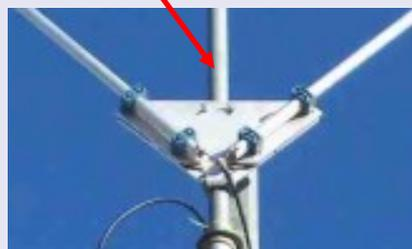
Le balun 1/1 est une option que je n'ai pas utilisée. Juste fait 2 tours avec le câble coaxial et branché directement celui-ci à l'antenne.
