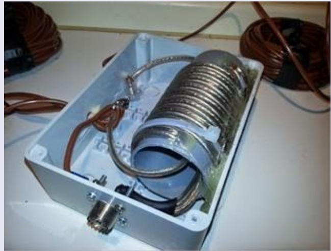
**Remarque :** dans ce mode de réalisation, on voit les trois radiales sortir d'un seul trou. Au lieu de cela, il est recommandé de les sortir de la boîte séparément, même si l'antenne fonctionne de toute façon. Cette astuce facilite le réglage.
