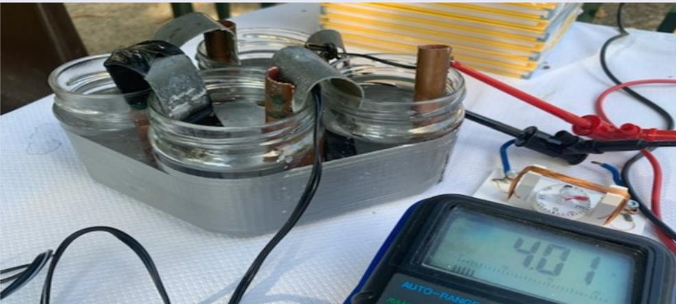
La pile de Volta (Zinc / Cuivre) générait 4 volts (1 volt par élément) et permettait d'éclairer (faiblement !) une LED rouge
