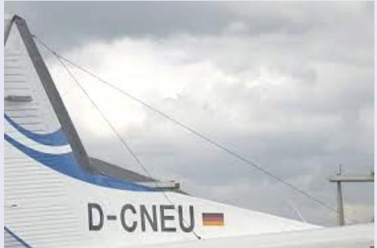
Antenne oblique en « V » renversé 2 à 23 MHz, tendue de la coque de l'avion à la dérive.
