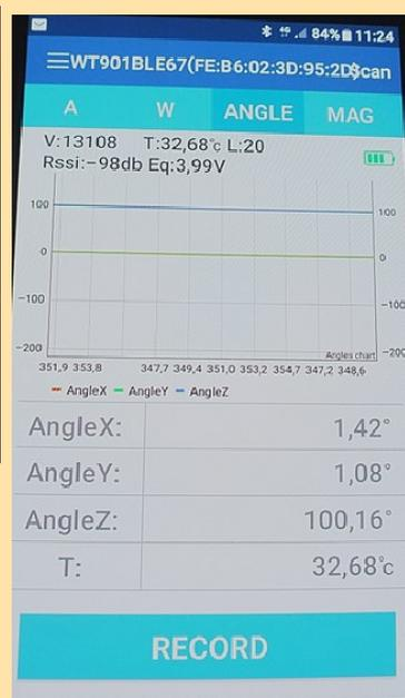
L'inclinomètre bien aligné sur le boom de l'antenne et la lecture sur le portable
