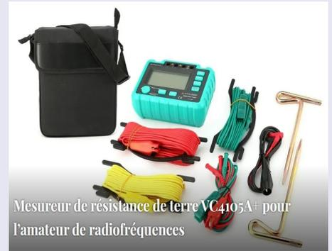
Mesureur de résistance de terre VC4105A+ pour l'amateur de radiofréquences
