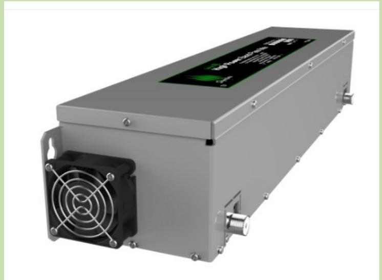
Par exemple, le filtre 20 m série XL réduit les signaux transmis et reçus sur les bandes 40 m et 15 m d'environ 55 dB ou plus avec des chiffres de rejet plus élevés sur les bandes plus éloignées de la bande principale. Voir les tracés VNA dans cette section pour les unités typiques. Les filtres de la série XL sont réglés manuellement et il existe de légères différences entre les unités.
