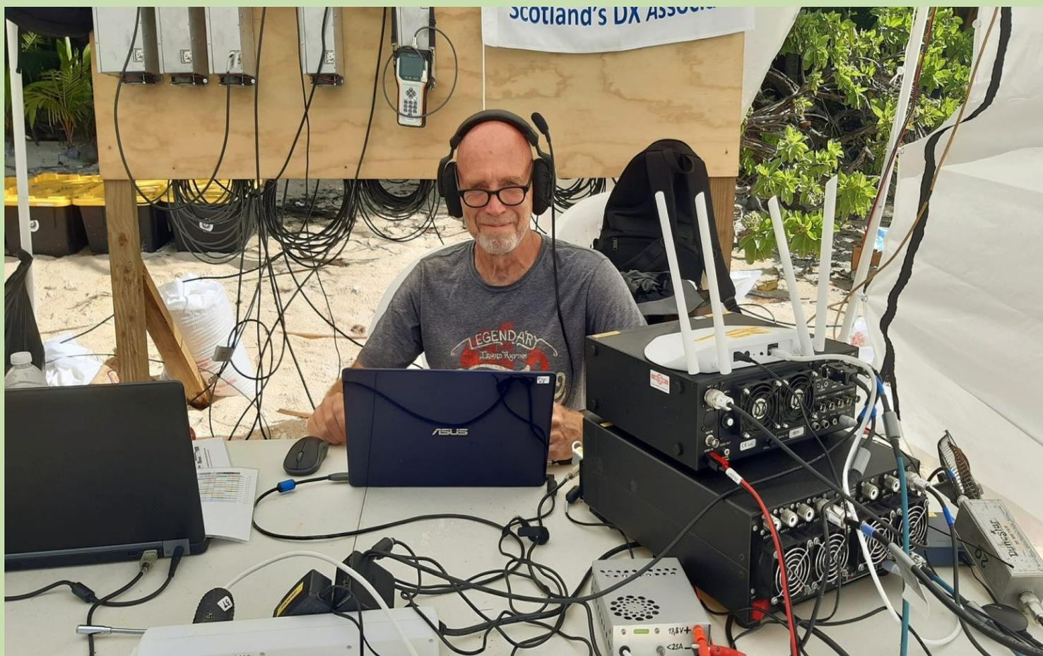
Chaque camp disposera de 3 stations entièrement équipées, d'amplificateurs K3(S) et SPE. Entre le K3 et le SPE, nous aurons des BPF de 100 W et entre le SPE et l'antenne, nous utiliserons les BPF haute puissance 403A.
