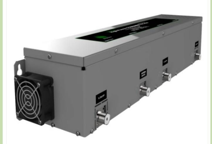
Le système triplexeur HF haute puissance 403A permet à une antenne tribande unique de 20 m/15 m/10 m (généralement un Yagi) alimentée par une seule ligne d'alimentation coaxiale, d'être utilisée par trois stations fonctionnant simultanément à 4,5 kW.
