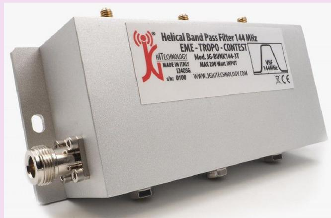
Filtre passe-bande VHF 144 MHz (2 mètres) entièrement en aluminium massif avec alliage anticorrosion 6060. Il permet une réception parfaite de la bande de 2 mètres de 144 à 146 MHz avec une faible perte d'insertion (typiquement 0,35 dB) Élimine complètement la diffusion FM de 88 à 108 MHz grâce à une atténuation de plus de 90 dB
