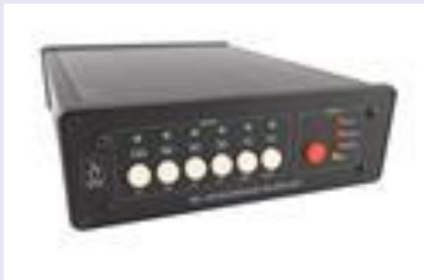
CMF2000 : **Le Diamond CMF2000 est** un filtre de mode commun qui empêchera les interférences TVI et EMI CEM causées par le câble coaxial de transmission.
