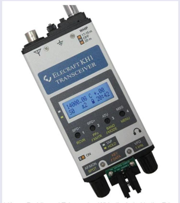
Nous venons de résoudre certains des problèmes les plus difficiles liés au déploiement sur le terrain HF : comment vous mettre en ondes en quelques secondes, avec une ATU interne qui règle à la fois un fouet multi bandes intégré et des fils aléatoires connectés en BNC.
