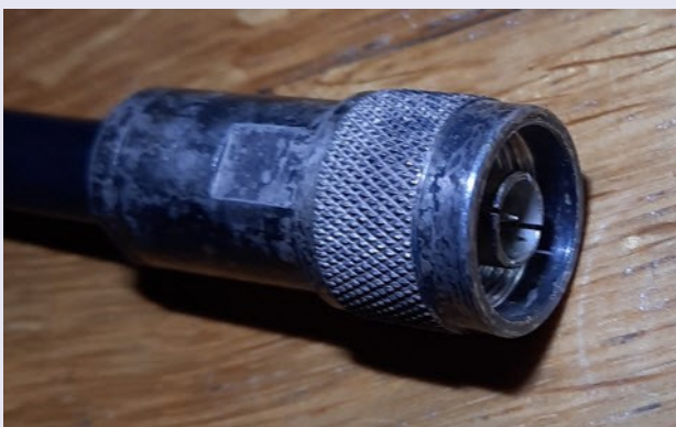
Connecteur type N mâle droit clamp pour câble coaxial RG213. Photo : ON4IJ
