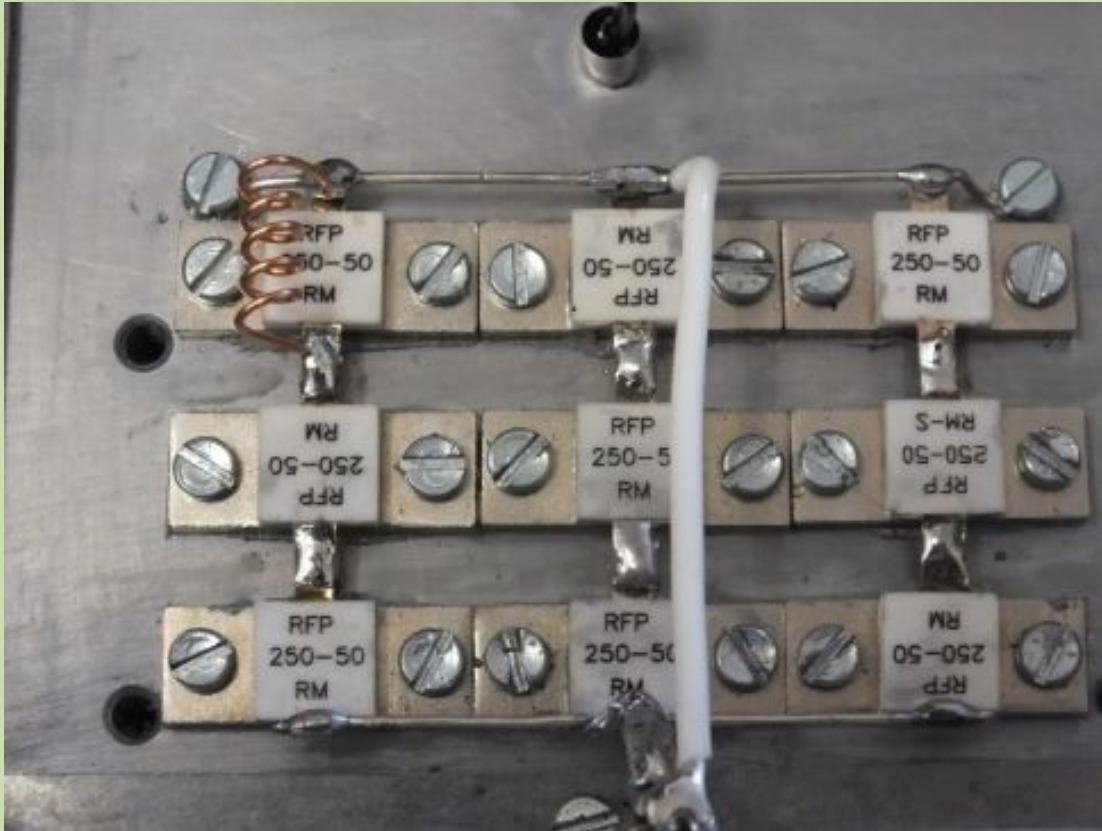
Câblage en série-parallèle pour obtenir 50 Ohms - 3 en séries et les 3 en séries mises en parallèle
