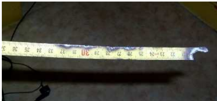
Contact de l'antenne avec une ligne électrique.
