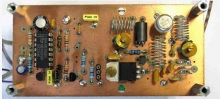
Uniquement par programmation du DDS, la même balise peut tout aussi bien fonctionner sur la fréquence d'exercice ADRASEC (121,375 MHz) (Photo 2) que sur une fréquence VHF pour une chasse au renard.
