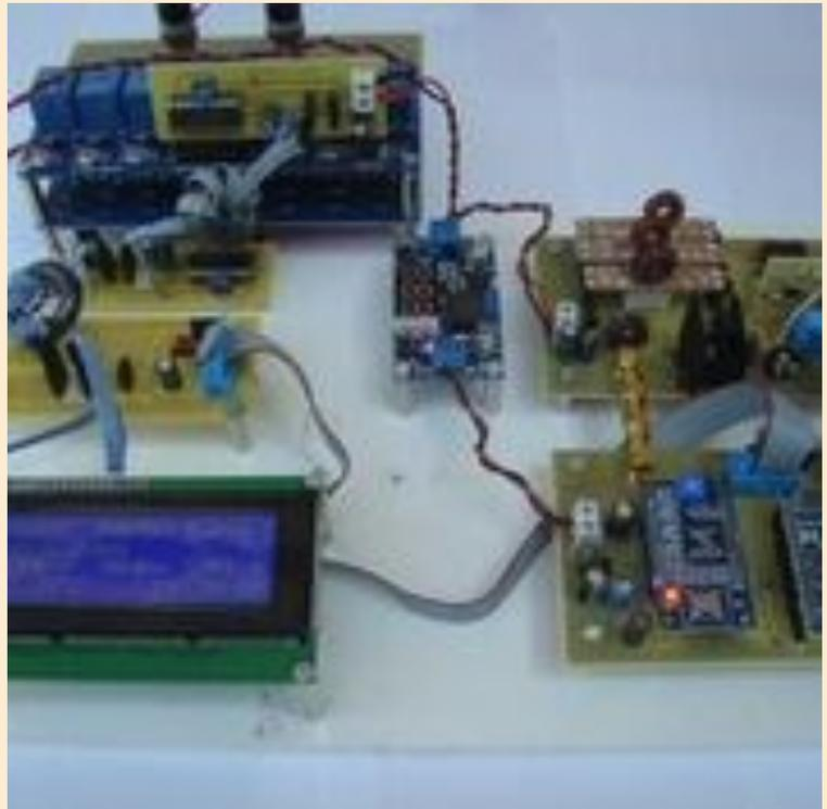
L'ensemble est architecturé autour d'un arduino nano, celui-ci pilote un module AD9850 par liaison série matérielle (SPI). L'alimentation de l'AD9850 est contrôlable par l'arduino ce qui permet de réduire la consommation dans le cas où la balise est alimentée par une batterie.
