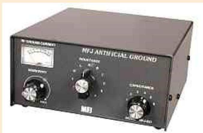
Elle est conçu pour être utilisé avec un contrepoids ( c'est à dire un fil ou des fils remplacé par un système au sol ).
