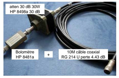
Banc de mesure de puissance RF à 2.32 GHz
