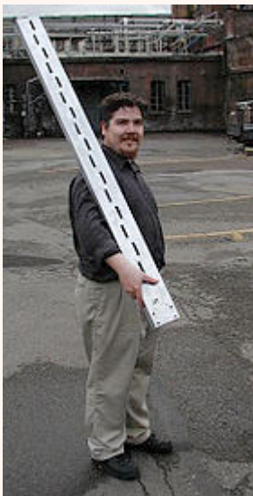
Antenne à fentes (type guide d'onde) pour onde de 2,4 GHz
