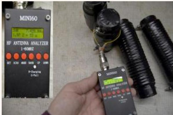
Toujours peu conventionnelle, cette trappe à la fréquence de coupure de 3,800 MHz, se vérifie au ROS le plus bas et l'impédance la plus basse.
