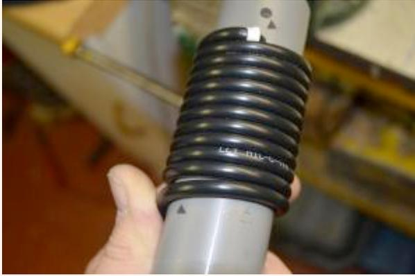
Enroulez fermement le câble coaxial autour du tuyau et les deux extrémités seront passées dans les trous.
