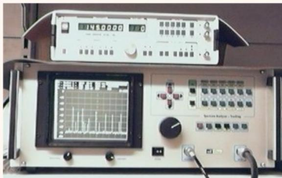
Générateur et analyseur de spectre 1 GHz
