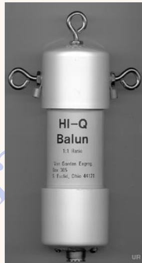
Le balun est simplement un transformateur d'impédance servant à adapter une ligne symétrique (l'antenne) à une ligne non symétrique ou asymétrique (le câble coaxial), d'où son nom Balun pour "Balance-Unbalanced".
