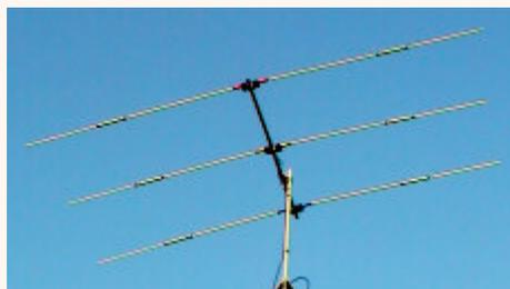
L'antenne Yagi, c'est une antenne directive. La position des divers éléments modifie l'impédance qui varie de **18 à 25 ohms** au lieu des 73 ohms du dipôle d'origine.
