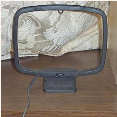
**Les antennes à petites boucles** ont une mauvaise efficacité et sont principalement utilisés comme antennes de réception dans les basses fréquences, les autoradios, la radiogoniométrie...
