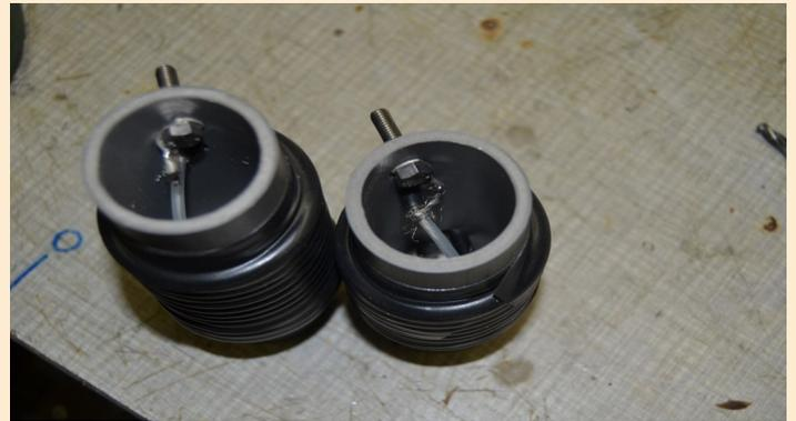
Dénudez et retirez l'isolation pour connecter l'âme avec la tresse comme sur le schéma plus haut, puis soudez le tout. L'âme d'un bout doit être solidaire de la tresse de l'autre bout et vice-versa. À l'aide d'une cosse, connectez l'âme et la tresse respectivement aux vis des extrémités.
