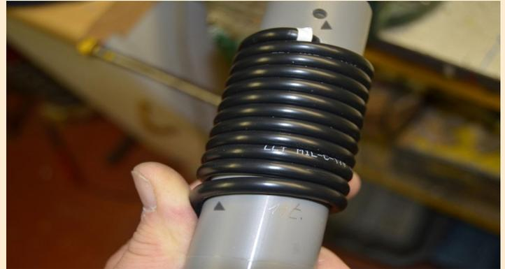
Enroulez fermement le câble coaxial autour du tuyau et les deux extrémités sont introduites dans les trous.
