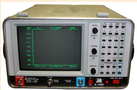
**1986** Analyseur de spectre IFR Aeroflex, A-7550
