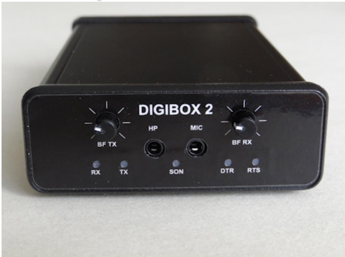
La façade avant permet de régler les niveaux BF et permet de visualiser le fonctionnement de la Digibox2.
