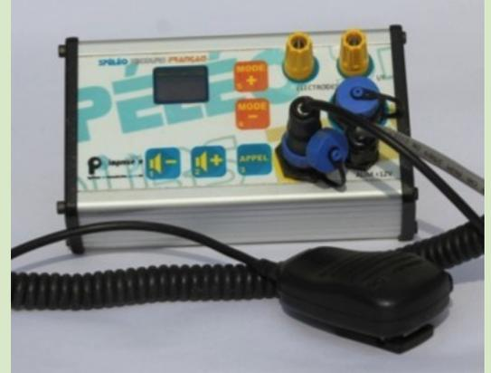
L'émetteur injecte dans le sol, entre deux piquets métalliques distants d'une centaine de mètres, un « courant vibré » commandé par le manipulateur de signaux Morse.
