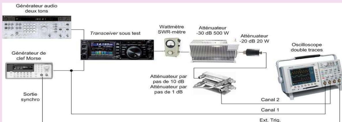
Fig. 91 : Setup de test pour l'analyse dans le domaine du temps des formes d'ondes transmises par un émetteur en télégraphie. Graphisme : ON4IJ.
