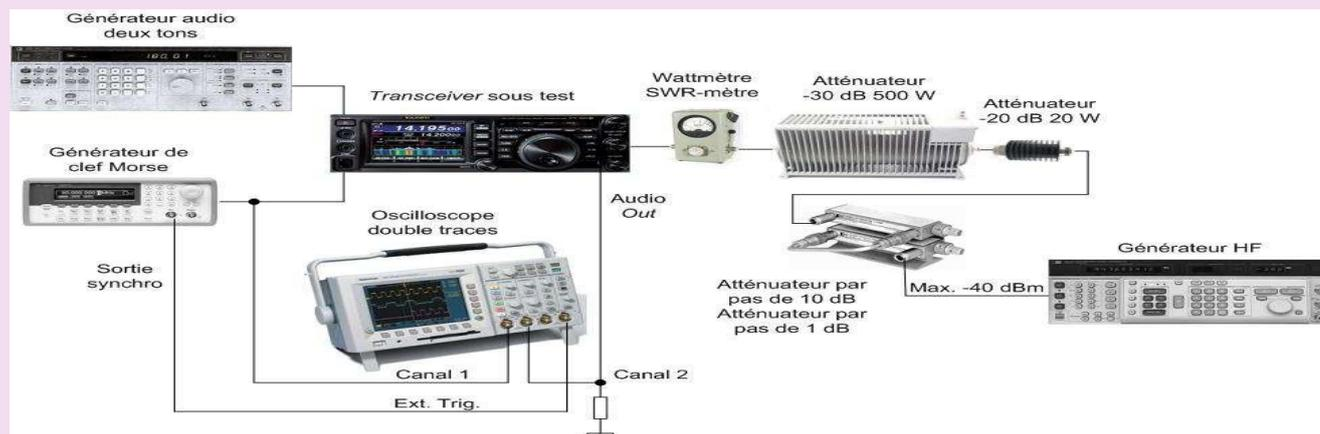
Pour la mesure du temps de réponse émission/réception, le générateur de clef Morse est utilisé de la même manière que celle du test précédent.
