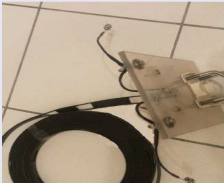
Détail des fixations de l'isolateur d'antenne
