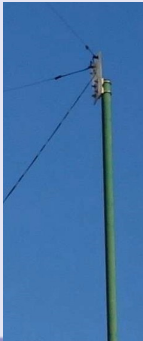
Isolateur assemblé et monté en haut du mât central
