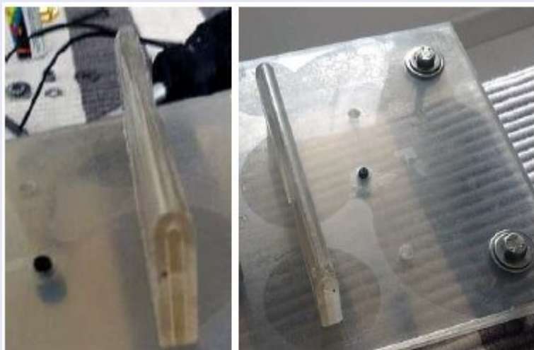
Détails de la barrette arrondie sur l'isolateur central : rôle important pour ne pas blesser le Twin-lead coté tirage.
