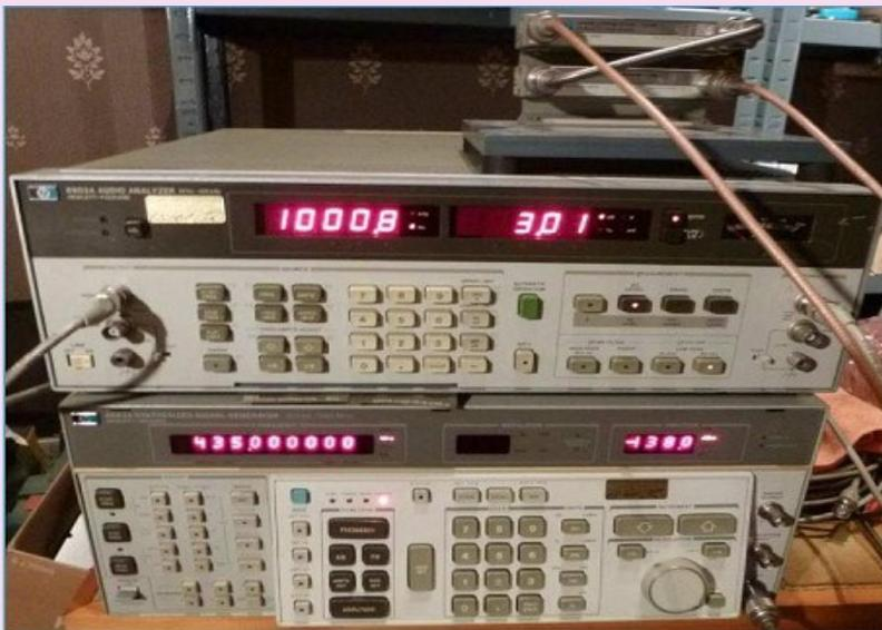
Exemple d'un générateur HF (HP 8662A), d'un analyseur audio distorsiomètre (HP 8903A) et (au-dessus à droite) d'un atténuateur par pas de 10 dB (HP8496B) et de 1 dB (HP 8494B) pouvant servir aux relevés des mesures de la sensibilité d'un récepteur.
