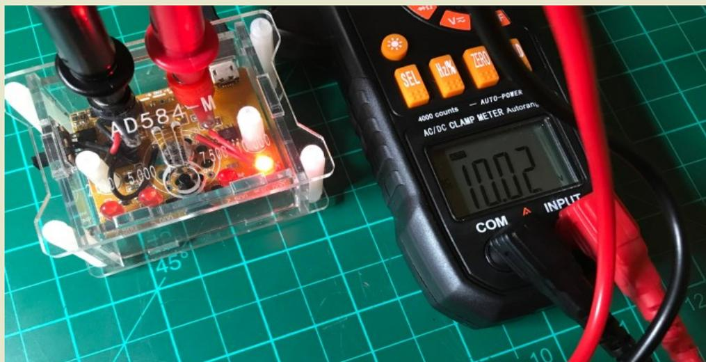
Avec la source de tension positionnée à 7.5 V, j'obtiens : 7.51
