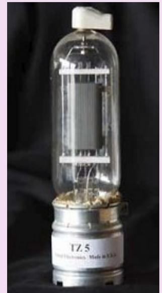
Les spécifications du tube montre qu'il peut être monté dans n'importe quelle position mais attention ça chauffe... et bien !!
