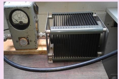
Bird et charge 50 ohms 1 Kw
