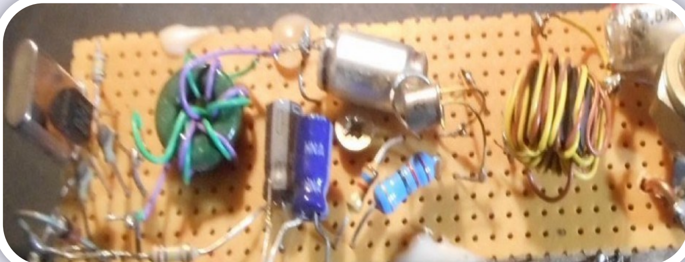
Montage réel l'émetteur 3.580.4 mhz
