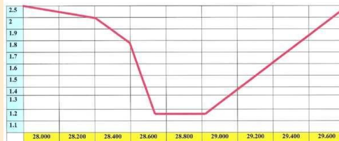
COURBE DU R.O.S SUR LA BANDE DES 28 Mhz ANTENNE 4 BANDES MONTÉE EN V INVERSÉ
