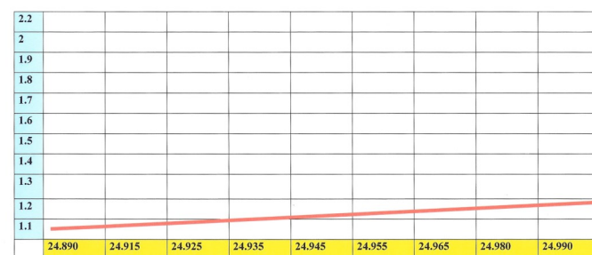
COURBE DU R.O.S SUR LA BANDE DES 24MHz ANTENNE 7 BANDES MONTÉE EN V INVERSÉ
