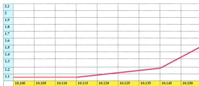
COURBE DU R.O.S SUR LA BANDE DES 18MHz ANTENNE 7 BANDES MONTÉE EN V INVERSÉ
