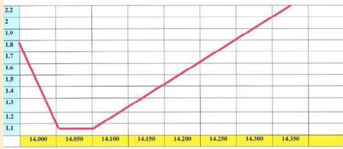
COURBE DU R.O.S SUR LA BANDE DES 21 Mhz ANTENNE 4 BANDES MONTÉE EN V INVERSÉ
