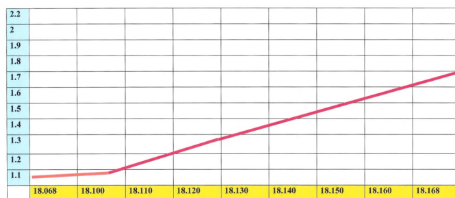
COURBE DU R.O.S SUR LA BANDE DES 18MHz ANTENNE 7 BANDES MONTÉE EN V INVERSÉ
