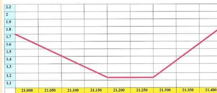
COURBE DU R.O.S SUR LA BANDE DES 28 Mhz ANTENNE 4 BANDES MONTÉE EN V INVERSÉ
