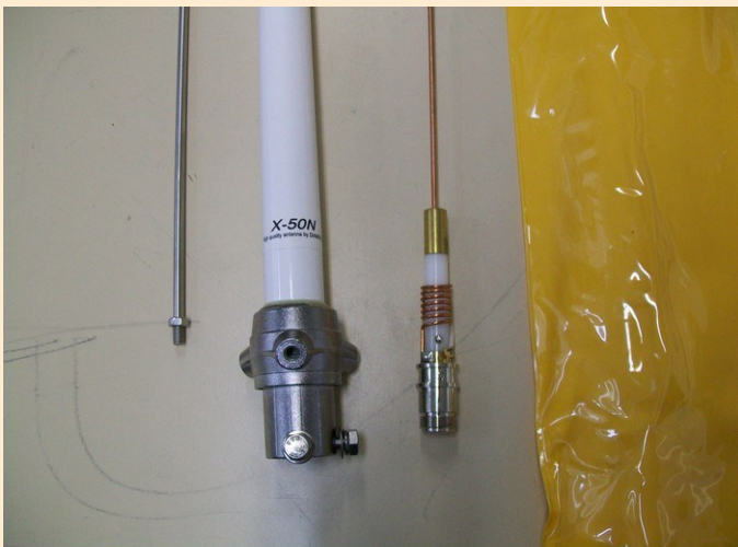
Gros plans; bas de l'antenne avec système LC vu précédemment, manchon en laiton connecté à un brin en cuivre.
