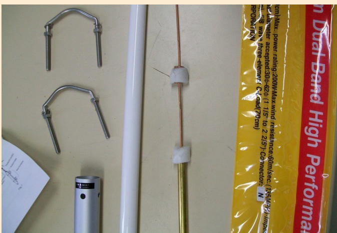
Haut de l'antenne; c'est la fin du cylindre en laiton, puis après quelques centimètres une nouvelle self.
