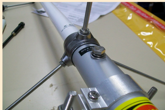
Serrez les radians à la main puis bloquez avec une clé de 8 et si possible pas trop fort.
