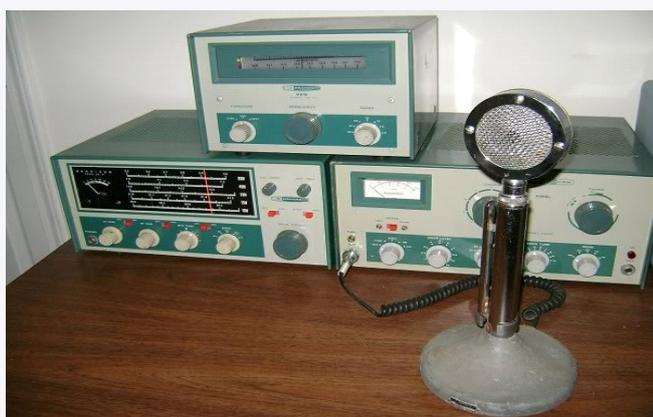
**A gauche le récepteur HR-10, à droite l'émetteur DX-60, dessus le VFP HG-10.**
