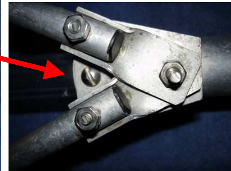
Traverses diagonales vissées à l'AVANT
